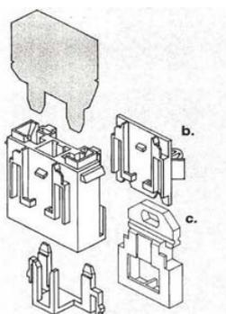
**Nosač za fiksiranje kućišta releja (b.)**
