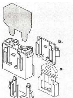
**Nosač za fiksiranje kućišta releja (c.)**
